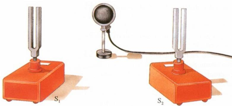
aus der Ruhelage beschreibt. Gehen von beiden Schallquellen gleichzeitig Töne aus, so wird die Bewegung eines Punktes der Membran durch die Funktion  $f : t \mapsto f_1(t) + f_2(t)$  beschrieben.
