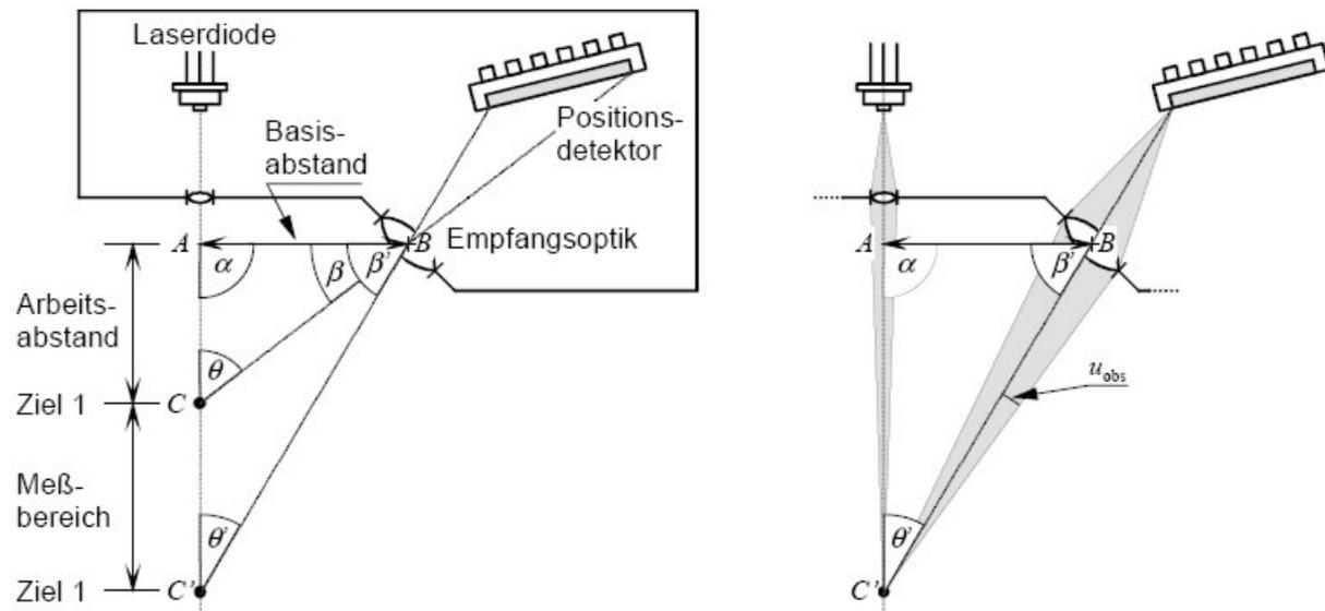
b) Die Auswertung der Abstandsmessung erfolgt mit Hilfe eines Mikrocontrollers, der mit einem Softwarealgorithmus die Entfernung bestimmt. Der Basisabstand eines Sensors betrage 20 mm. Wie lautet die Funktion, nach der das Softwareprogramm den Abstand zum Messobjekt berechnet?
